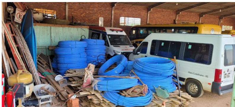
Figura 33: Tubulação para rede de abastecimento de água.
